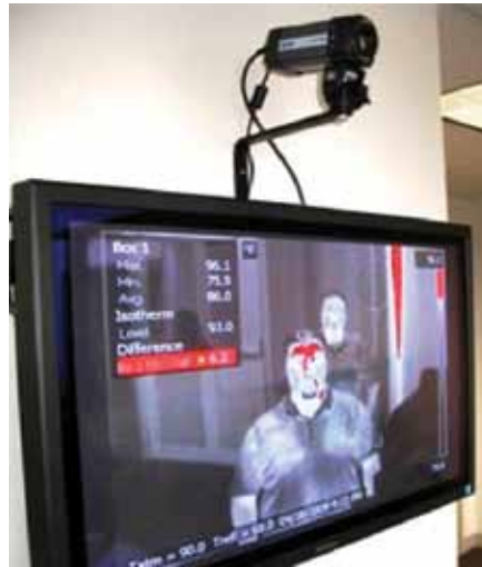
FLIR A320 ad installazione fissa con l'allarme colore in funzione.
